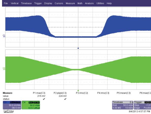
图37 – 电压跌落测试，0.5 V/秒。电源能够正常操作，而无人任何故障和闪烁。 Ch4: V_{IN} , 50 V/格 Ch3: I_{OUT} , 50 mA/格 时间量程: 50 s/格
