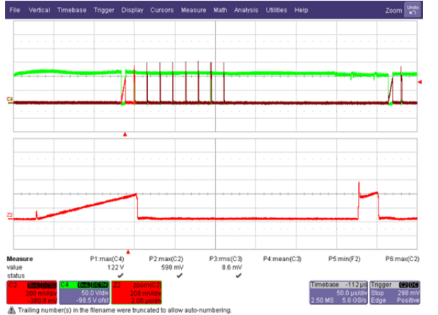
Figure 27 – 90 VAC / 60 Hz Start-up. Ch4: V_{D-S} ; 50 V / div., 50 \mu s / div. Ch2: I_{D-S} ; 200 mA / div., 50 \mu s / div. Z2: I_{D-S} ; 200 mA / div., 2 \mu s / div.
