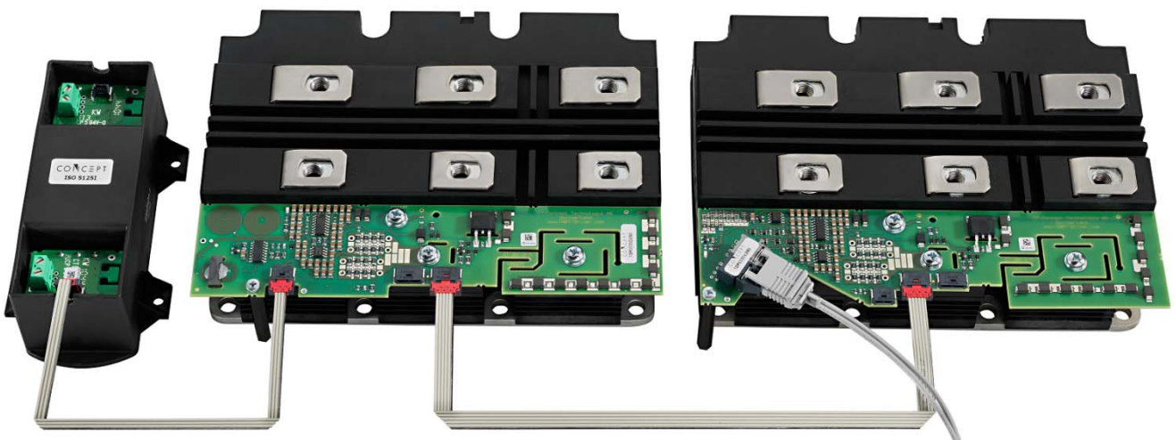
图1 1SP0335D（从板）与1SP0335V（主板）分别用螺丝固定到6.5kV IGBT模块上（左：连接到1SP0335D的DC/DC电源ISO5125I）
